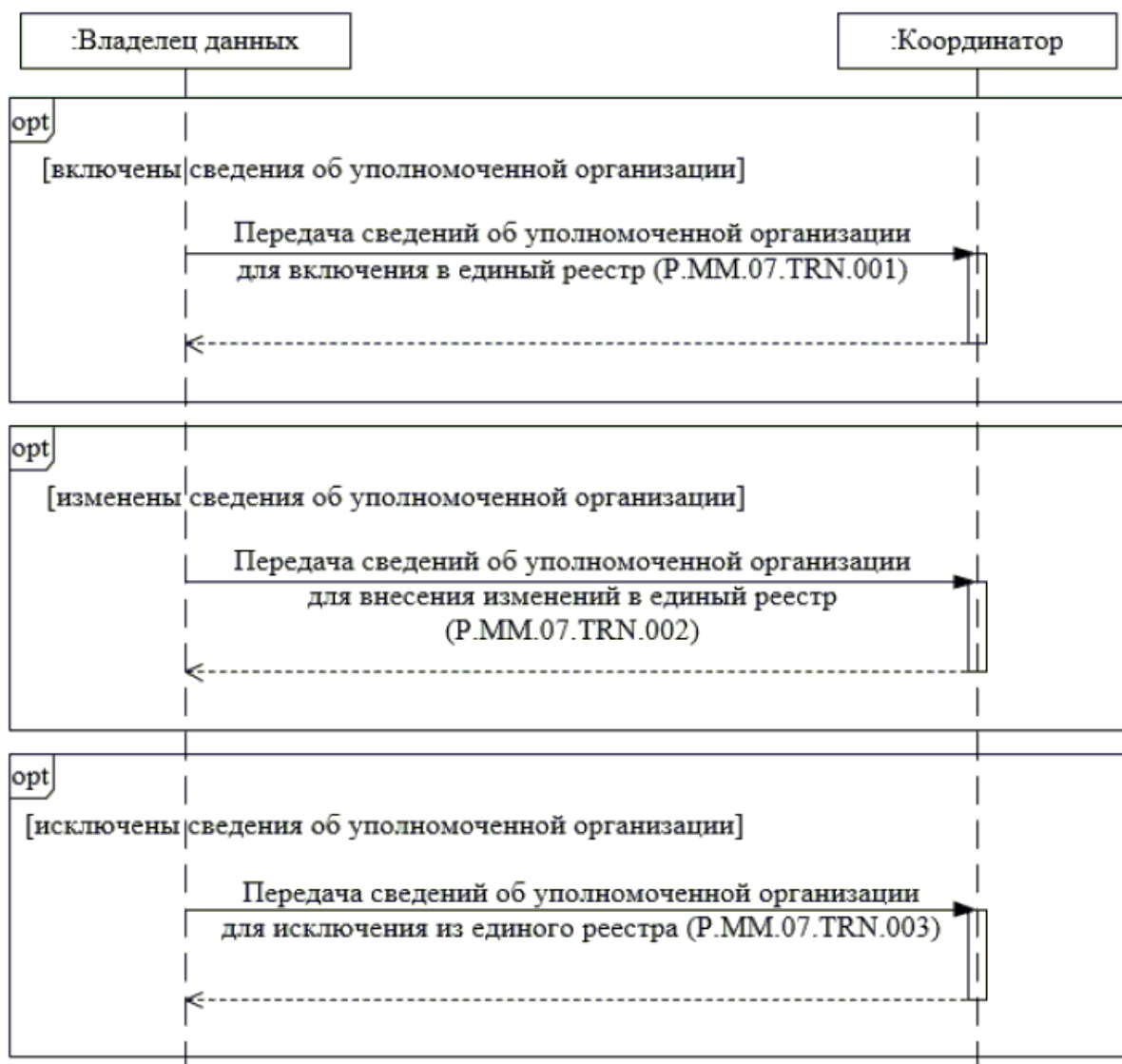
Рис. 2. Схема выполнения транзакций общего процесса при формировании и ведении единого реестра
